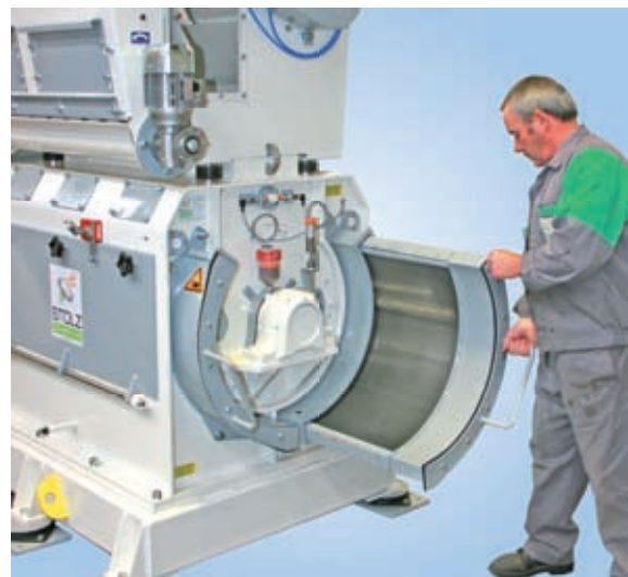
Changement manuel des grilles en marche avec carter de sécurité
