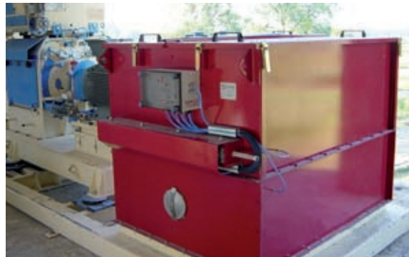
Filtre à poches sur installation de broyage
