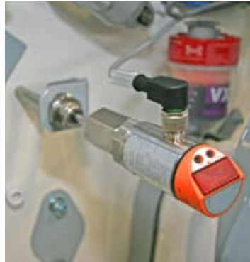
Contrôle de température sur chambre de broyage
