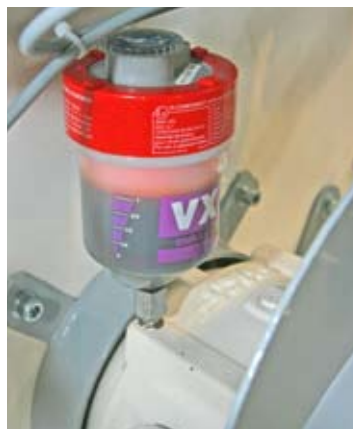
Graisseur automatique des paliers
