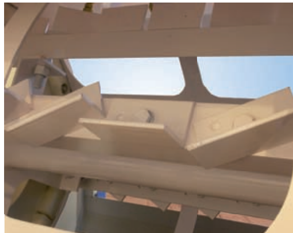
Rotor à batteurs pré-orientés
