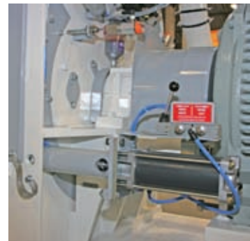
Extraction pneumatique des grilles
