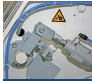
Verrouillage pour étan- chéité des grilles
