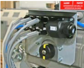
Répartiteur pour raccordement rapide à la supervision
