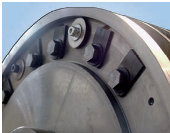
Masselottes d'équilibrage vissées sur un rotor
