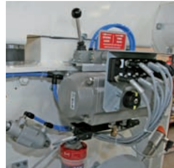
Actionneur rotatif pour orientation du volet d'alimentation
