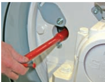
Changement rapide des axes de marteaux avec outillage spécifique fourni
