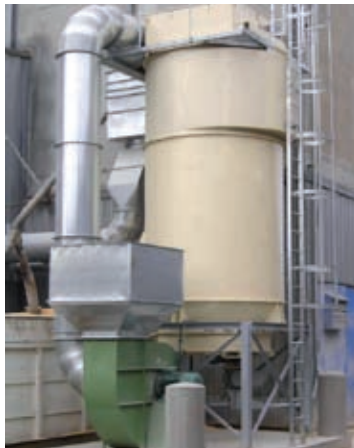
Cyclofiltre avec reprise par transport pneumatique
