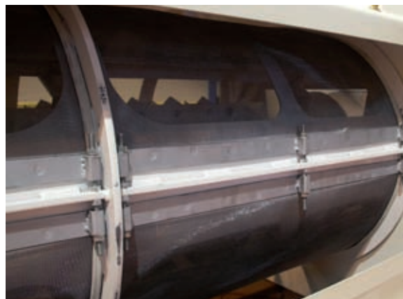
Montage aisé et étanche des garnitures
