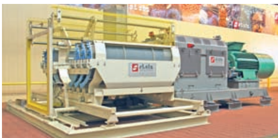
Sélecteur automatique de grilles autonome
